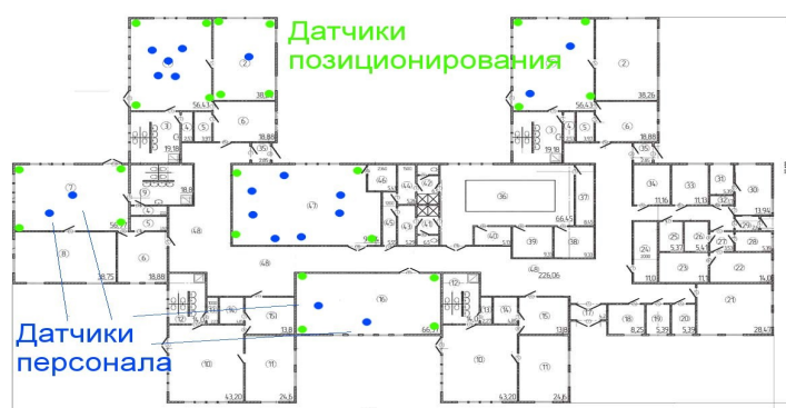
Иллюстрация 8: Учет персонала в контролируемом помещении при помощи РСС
