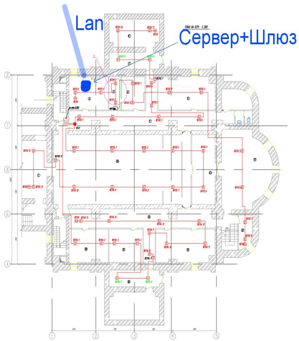
Иллюстрация 13: Использование РСС для систем автоматической пожарной сигнализации
